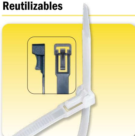
Un sistema de reapertura formado por una palanca unida al trinquete de retención permite la apertura rápida del cierre sin afectar sus características para sucesivas utilizaciones.
