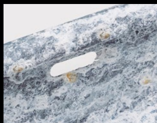
Acabado galvanizado en caliente estándar después de 700 horas Standard hot dip galvanized finish after 700 hours
