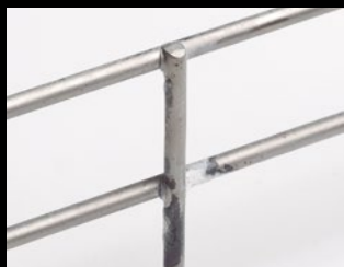
Acabado HR después de 1000 horas HR coating after 1000 hours
