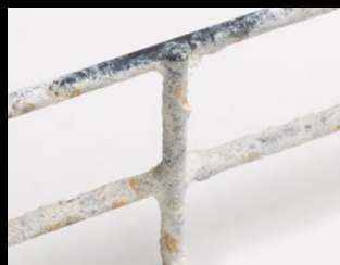
Acabado galvanizado en caliente estándar después de 600 horas Standard hot dip galvanized finish after 600 hours
