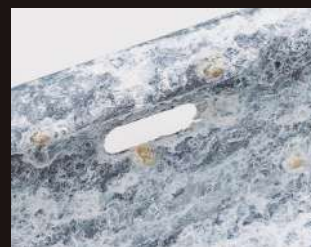
Acabado galvanizado en caliente estándar después de 700 horas
